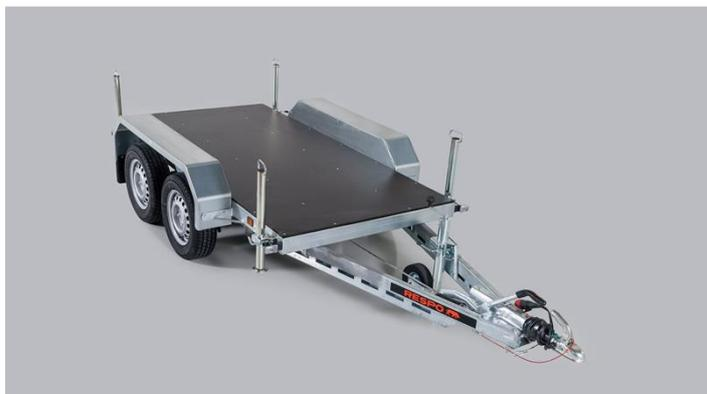
Eine ideale Lösung für die Bereitstellung einer mobilen Energiequelle für Objekte oder Veranstaltungen im Freien. Der für den Transport des Generators entwickelte Anhänger ruht auf einem extrem starken und langlebigen verzinkten Schweißrahmen. Die hochwertige Doppeltorsionsfederung ist zuverlässig und sorgt auch unter schwierigen Bedingungen für mehr Stabilität.
