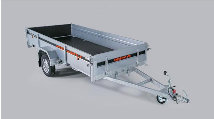
Super starker und langlebiger verzinkter geschweißter Rahmen. Ports und Fender mit erheblich hoher Tragfähigkeit bestehen aus verzinktem Blech mit Magnelis®-Beschichtung, das dreimal korrosionsbeständiger ist als standardmäßiges HDG-beschichtetes Blech. Starke 4-Blatt-Blattfedern, Stoßdämpfer, wasserdichte Naben sorgen für beste Fahreigenschaften und eine lange Lebensdauer.
