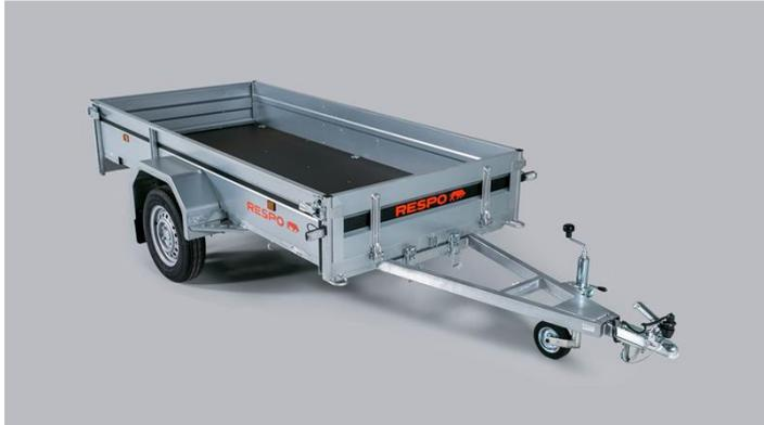
Super starker und langlebiger verzinkter geschweißter Rahmen. Ports und Fender mit erheblich hoher Tragfähigkeit bestehen aus verzinktem Blech mit Magnelis®-Beschichtung. Starke 3-Blatt-Blattfedern, Stoßdämpfer, wasserdichte Nabensorgen für beste Fahreigenschaften und eine lange Lebensdauer. Neben der Imprägnierung ist das untere Sperrholz auch mit einer rutschfesten Beschichtung versehen. Die vorderen und hinteren Türen sind abnehmbar.
